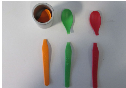
Abbildung 77 Abgebrochene Löffelköpfe und Prüfzylinder
